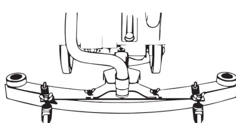
Совместите звездообразную гайку с прорезью расточной скобы и затяните гайку.
