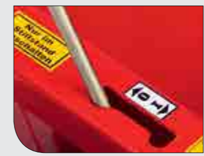
Включение/Выключение Управление включением / выключением производится с места оператора.
