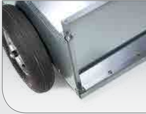
Задний борт легко откидывается для более удобной загрузки/разгрузки.
