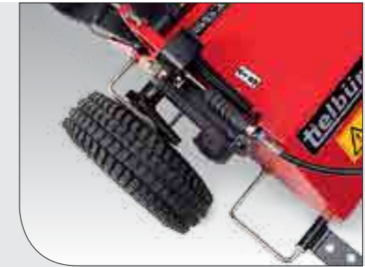
Регулировка рабочей глубины осуществляется с места оператора
