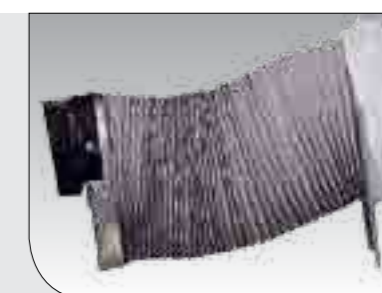
Гибкий рукав соединяет коллектор с трактором
