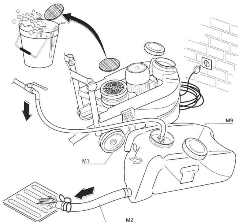
Для очистки фильтра и бака для грязной воды, после работы с машиной, необходимо:
