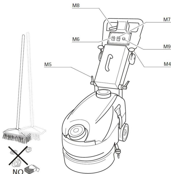
**Предупреждение:** машина предназначена для работы в помещениях и на уклонах не круче 2%. Запрещается работа с легковоспламеняющимися или взрывчатыми веществами.
